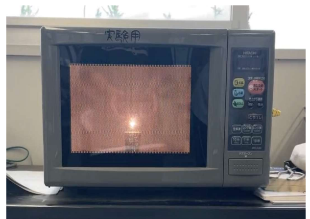
図2 プラズマが発生している様子
